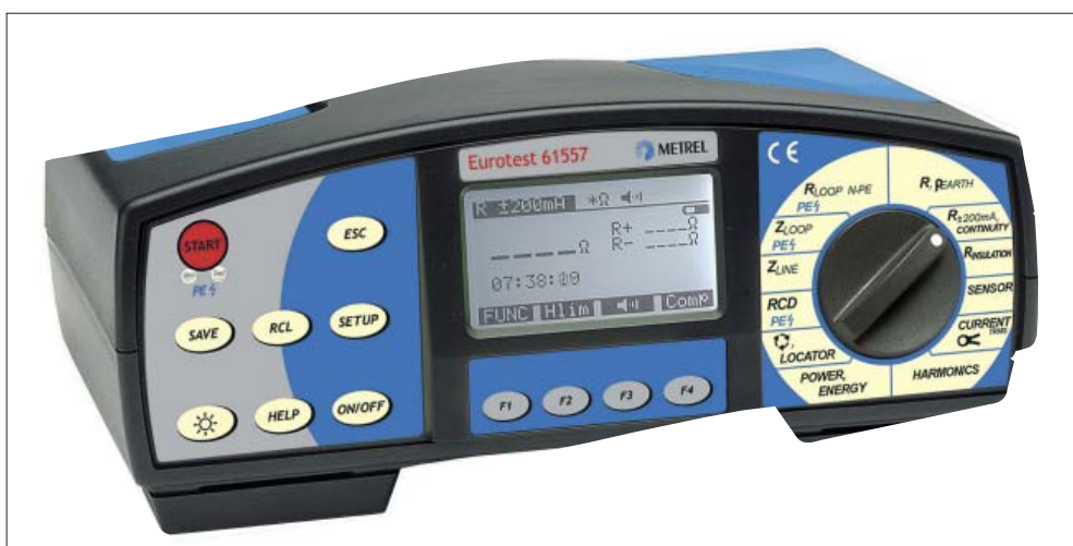
Figur 5.1. Måleinstrument anvendt til måling af overgangsmodstand til neutral jord for inventar- og bygningsdele i stalde.
