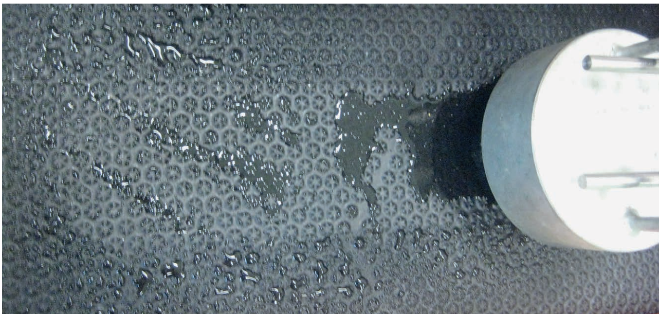
Bild 3: Messung der Rutschfestigkeit in nassem Zustand
